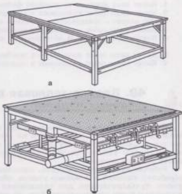
Рис. 68. Оборудование раскройного цеха: а — настилочный стол со сплошным покрытием; б — игольчатый стол
