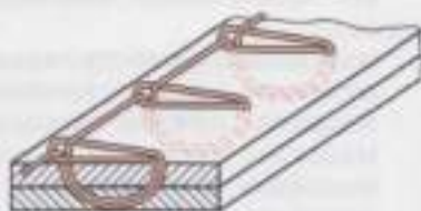
Рис. 4. Потайная строчка однониточного цепного стежка
