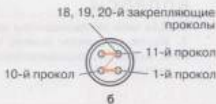
Рис. 30. Машина-полуавтомат 827-М класса: а — общий вид; б — схема пришивания пуговицы с четырьмя отверстиями
