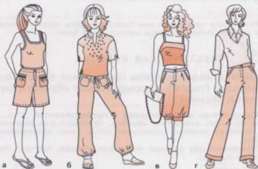
Рис. 89. Виды обработки нижних срезов брюк: а — швом вподгибку; б — резиновой тесьмой; в — притачной манжетой; г — цельнокроеной манжетой
