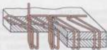
Рис. 3. Обмёточная строчка однониточного цепного стежка
