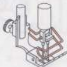
Рис. 16. Ограждение игл в машине 852 × 5 класса
