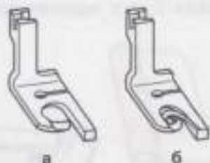
Рис. 34. Лапки-рубильники: а — для выполнения шва вподгибку с открытым срезом; б — для выполнения шва вподгибку с закрытым срезом
