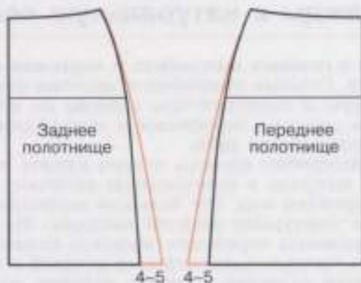
Рис. 63. Нанесение линий фасона на выкройке юбки платья, отрезного по линии талии, при разработке платья модели 4
